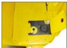
Accès facile au bouchon du réservoir de gasoil situé sur le plancher
