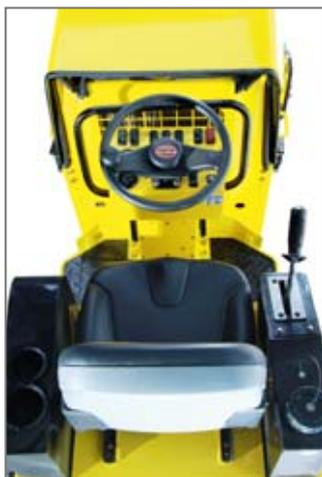
Siège ergonomique antivibratile avec contacteur de sécurité
