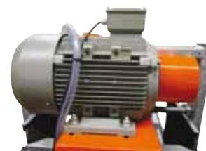
Puissant moteur électrique 5,5 kW
