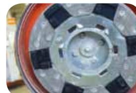
Montage des 6 outils de ponçage sur SM280
