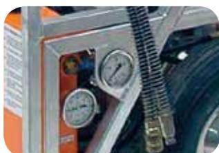
Châssis mécano soudé galvanisé et cadran pression et température d'huile
